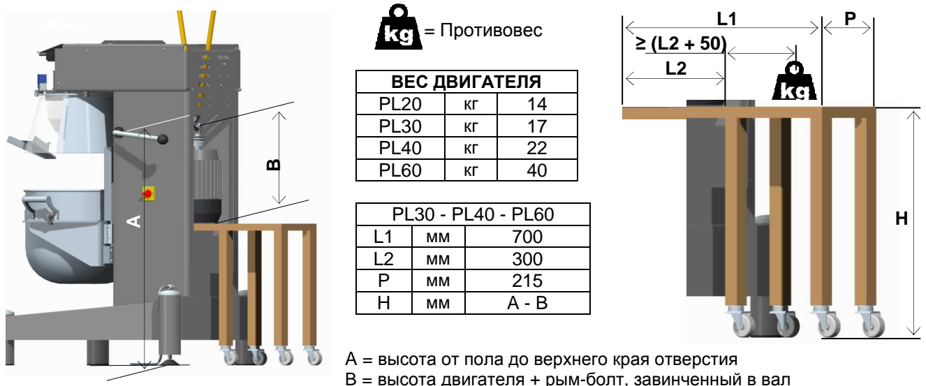
Рисунок 21– Инструмент для упрощения процедуры установки/демонтажа двигателя
