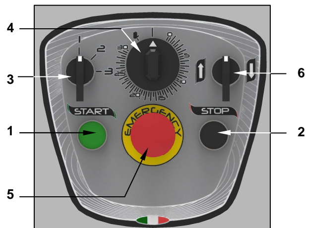
Рисунок 4 – Электромеханическая панель управления для версия N3A
