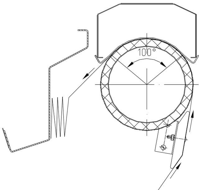
Рис. 4. Схема движения бѐльи в катке гладильном.
