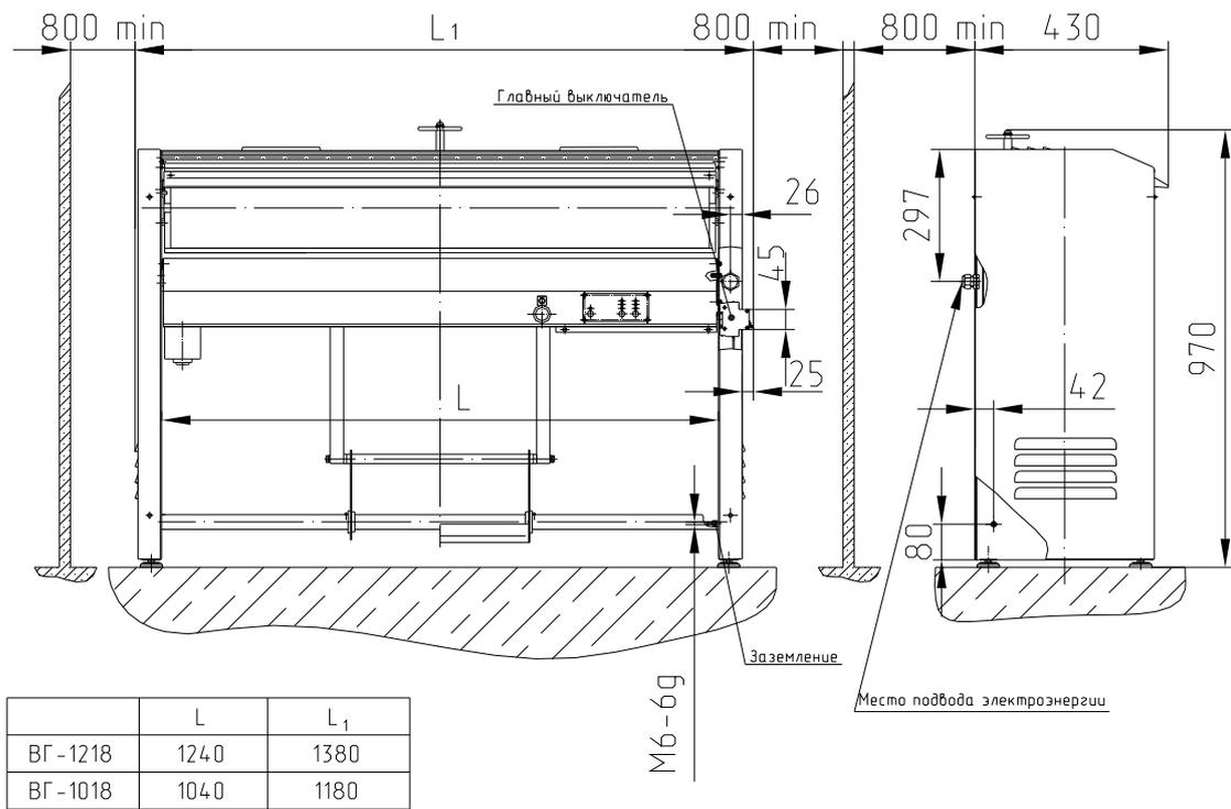
Рис. 7. Монтажный чертеж
