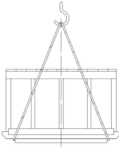
Рис. 9 Схема строповки катка гладильного,
