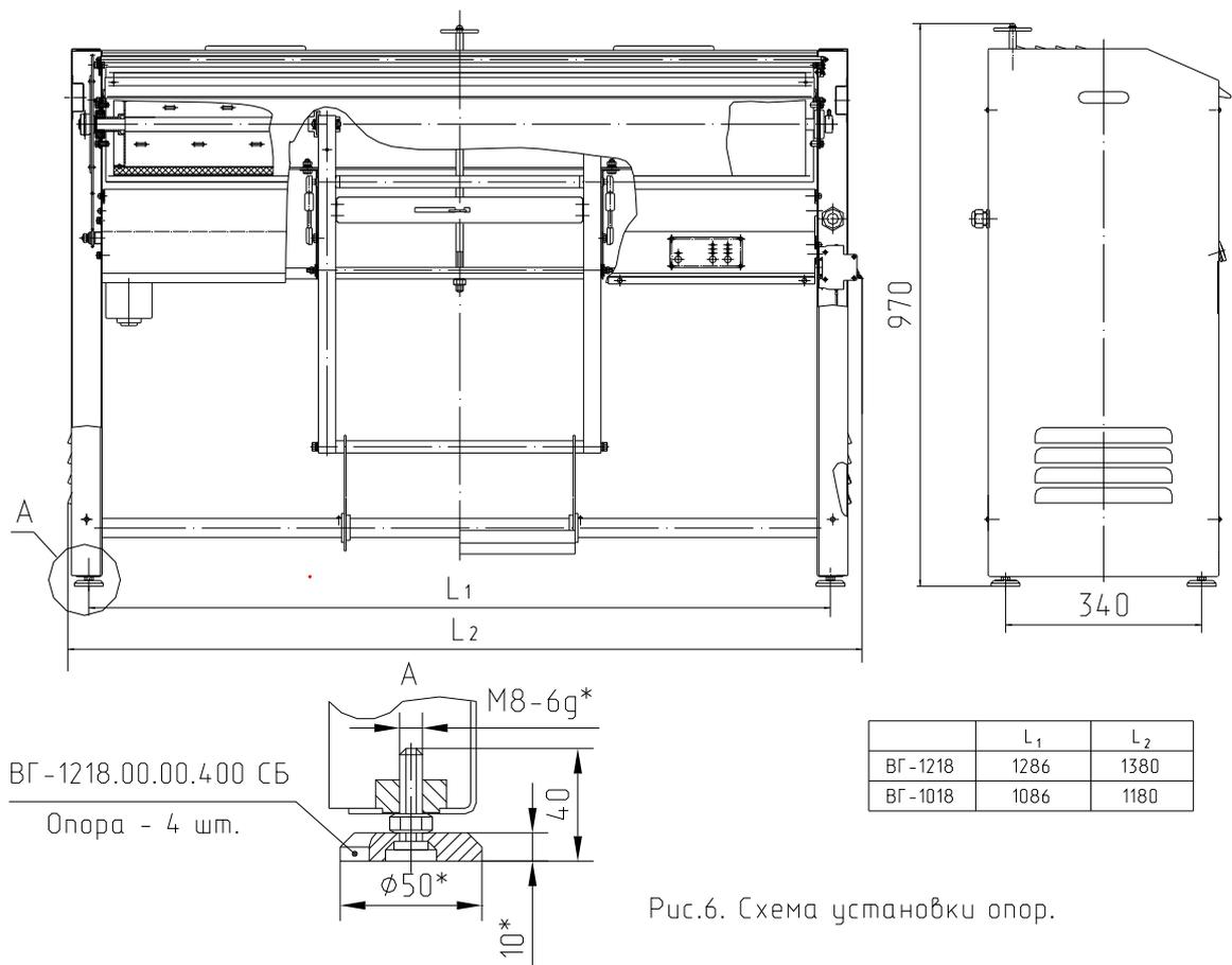
Рис.6. Схема установки опор.
